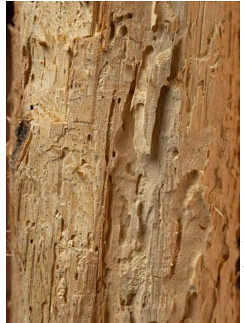
Bild 3: Fraßschäden am Splintholz verursacht durch die Larven des Hausbockkäfers.
